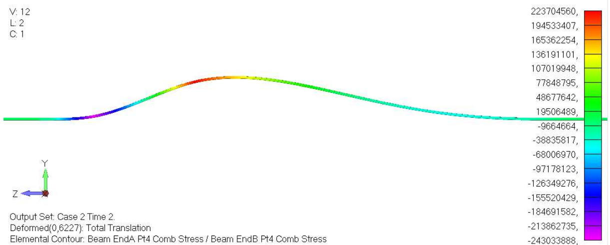
Рисунок 2.23 – Напряженно-деформированное состояние рельсовой плети (значения нормальных напряжений в точке 4 (высота подъема 0,25 м при вылете стрелы 6,82 м)
